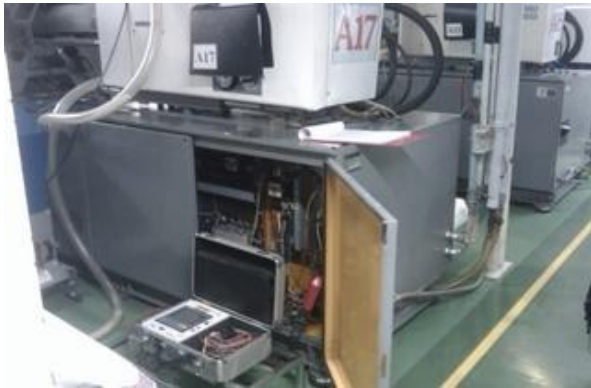
รูปที่ 12.5 การติดตั้งเครื่องบันทึกพลังงานไฟฟ้าแบบต่อเนื่อง
