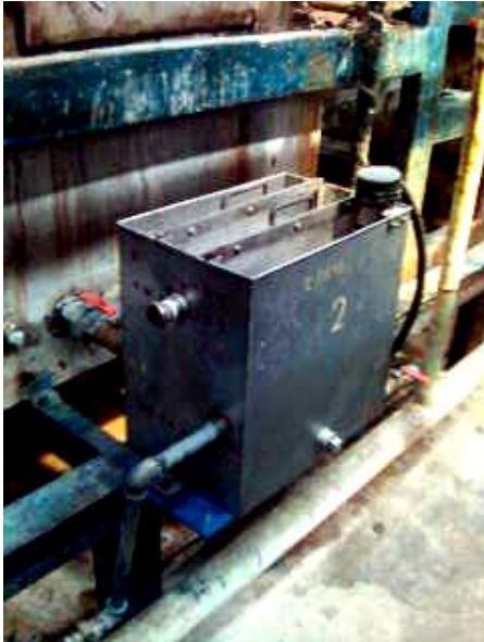
รูปที่ 10.6 ถังพักน้ำร้อนและเครื่องสูบน้ำกลับจากบ่อที่ 7 ไปยังบ่อที่ 5
