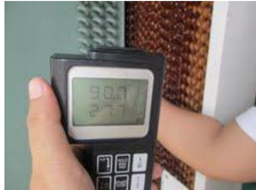
รูปที่ 9.13 รูปการตรวจวัดอุณหภูมิเข้าและออกจาก Cooling Pad
