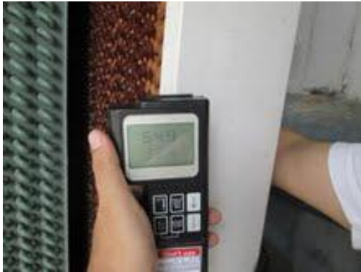
รูปที่ 9.13 รูปการตรวจวัดอุณหภูมิเข้าและออกจาก Cooling Pad
