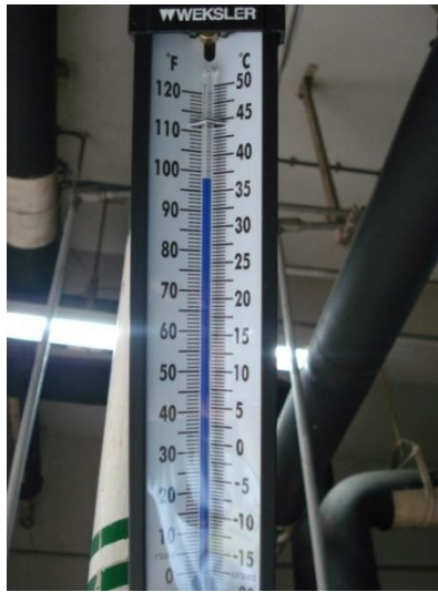
รูปที่ 8.8 อุณหภูมิน้ำหล่อเย็นก่อนเข้าเครื่องทำน้ำเย็น (ก่อนปรับปรุง)
