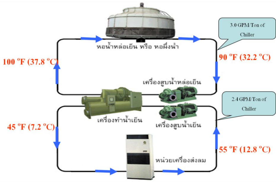
รูปที่ 6.2 แผนผังแสดงวงจรการทำงานของระบบปรับอากาศแบบรวมศูนย์โดยทั่วไปชนิดระบายความร้อนด้วยน้ำ
