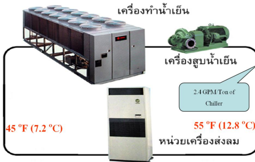
รูปที่ 6.3 แผนผังแสดงวงจรการทำงานของระบบปรับอากาศแบบรวมศูนย์โดยทั่วไปชนิดระบายความร้อนด้วยอากาศ
