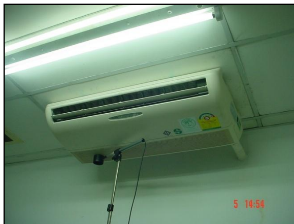
รูปที่ 5.5 ตัวอย่างการตรวจวัดความเร็วลม
